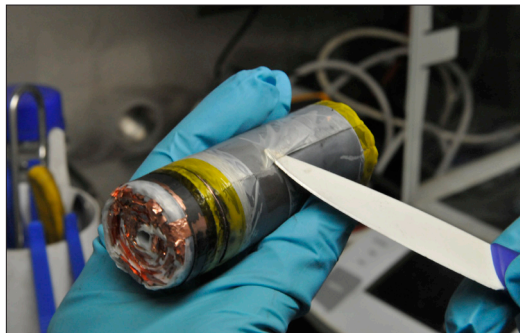
Demontage einer Lithium-Ionen-Batterie
